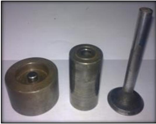
شكل (3) اجزاء قالب الكبس
