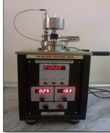
الشكل (6) جهاز قياس معدل البلى
