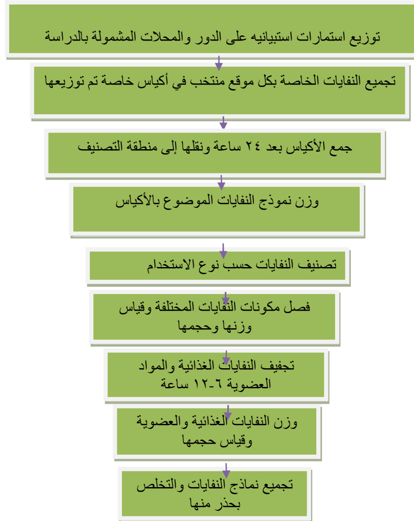
شكل رقم (٢): رسم تخطيطي يوضح طريقة جمع وتشخيص نماذج النفايات الصلبة التي تم جمعها
