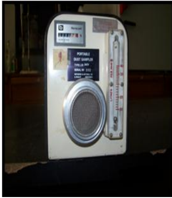
شكل(1). جهاز جمع سحب الهواء نوع سنفر لجمع عينات PM (PM type Sniffer)
