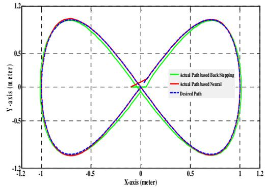
**Fig. 5. The desired and actual trajectory for mobile robot.**
