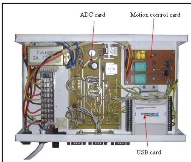
Fig. 5 Details of UDAC-2.
