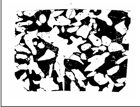
عينة فولاذ كاربوني ( 0.35 c% ) ( 840 C° ) ملدن قوة التكبير ( 150 X )
