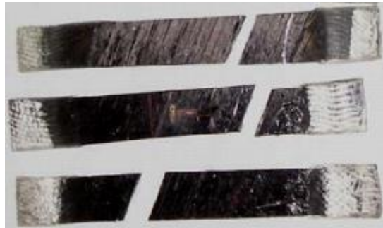
شكل (10) صور لفشل عينات اختيار الشد للمادة المركبة كاربون ايبوكسي وبزاوية اتجاه (0) وزوايا الاليف.
