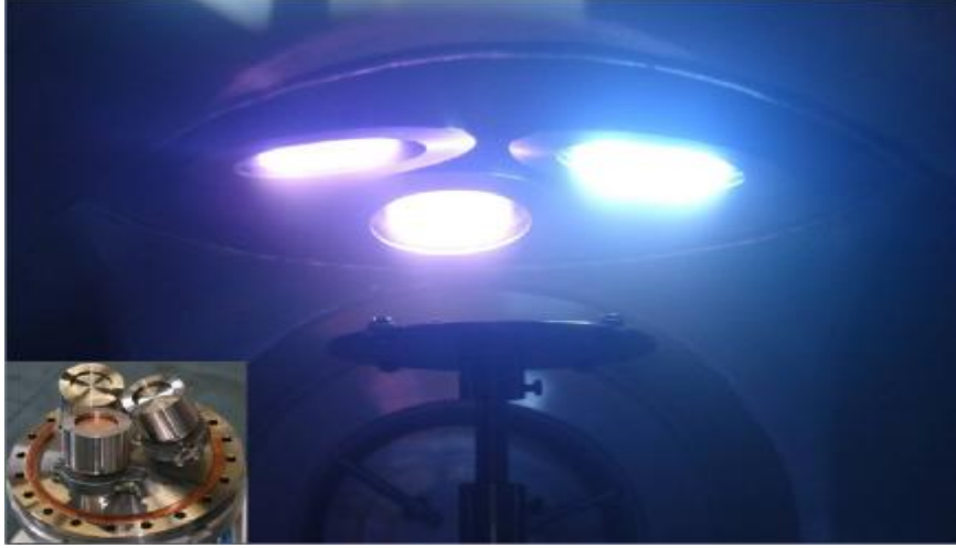
الشكل (1). الترسيب الفيزيائي من ثلاثة اقطاب من التيتانيوم-المنيوم-كربون في داخل حجرة الضغط
